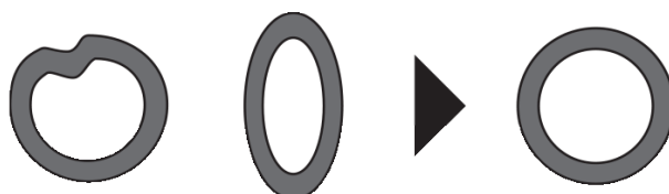
Slika: popravljanje odrezanega mesta na bovdnu
