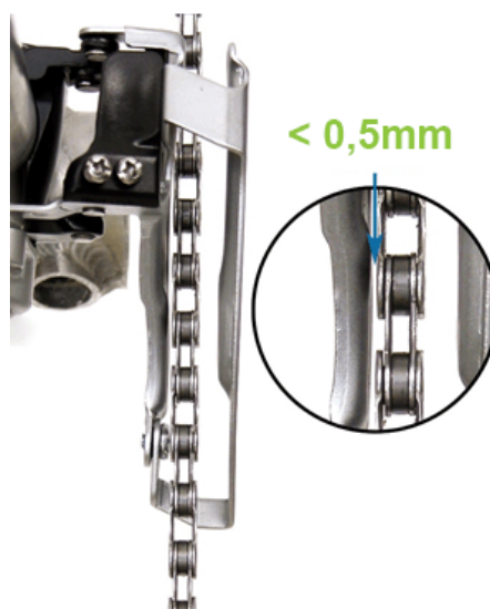
Slika: razdalja med verigo in notranjo ploščico vodila verige
