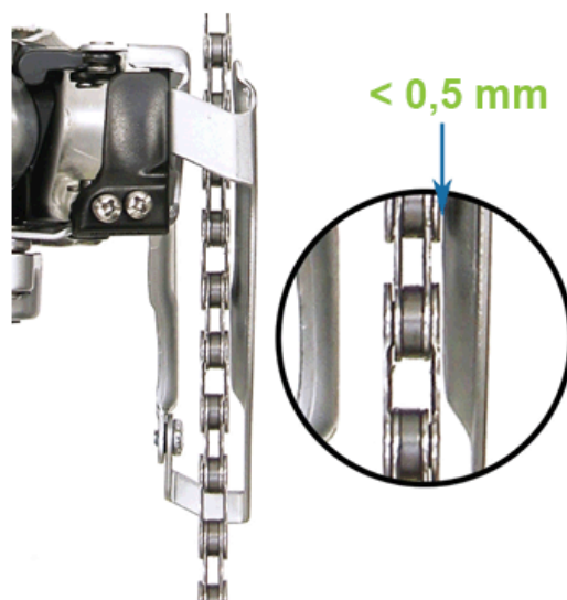
Slika: razdalja med verigo in zunanjo ploščico vodila verige
