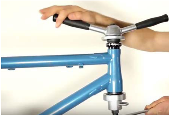
Slika: Stiskanje šalic krmilnega ležaja
