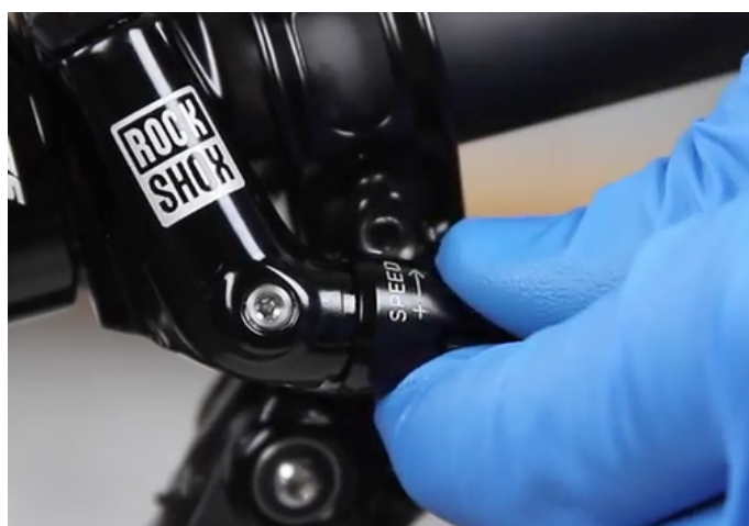
Slika: Nastavitev hitrosti vračanja
