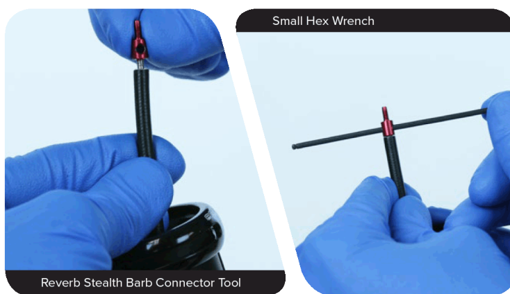
Slika: uvijanje konektorja v cevko
