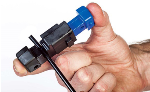
Slika: Krajšanje cevke s hidravličnim rezilom
